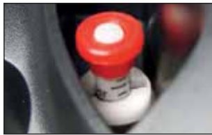
Kolbenmanometer mit eingebautem Sicherheitsventil
